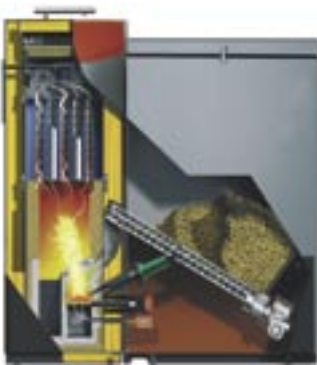
Schema einer Pelletheizung
